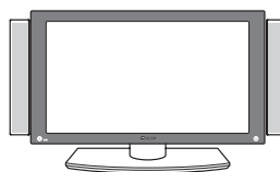
Altoparlanti installati sui lati destro e sinistro
